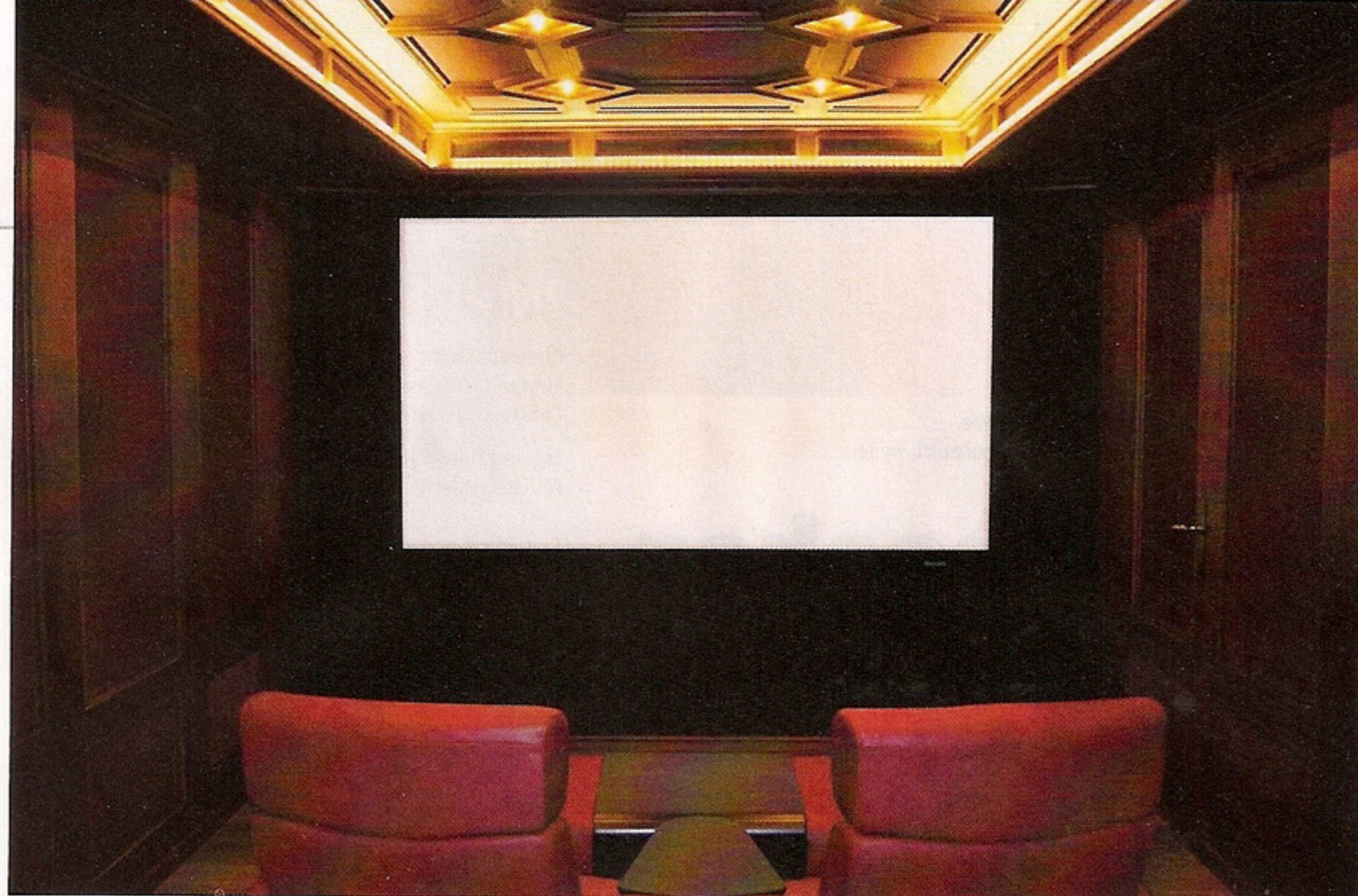
Die Leinwand: Die Stewart-Screen lässt sich herausnehmen, sie ist nur mit Klettbandern befestigt. Die Kastendecke füllt die Wölbung aus und sorgt gleichzeitig für stimmungsvolle Beleuchtung.
