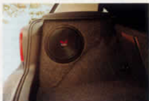
Bild 3 ...und so fertig eingebaut im linken Kofferraum-Seitenteil.
